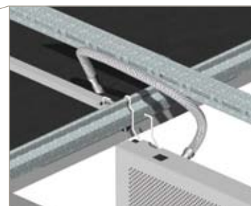
Particular abertura panel radiante metálico 600x600 Copper para intervenciones de mantenimiento e inspecciones
