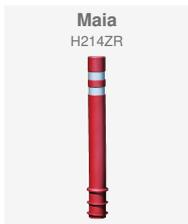
Pilona fabricada en poliuretano, con placa de refuerzo en acero inoxidable y con LED solar. Absorbe cualquier impacto de vehículos y recupera la verticalidad al 100%. Supera una flexión de 1500 ciclos a 45º y 50 ciclos a 90º, sin daños. Clasificación "E" de comportamiento al fuego, según norma UNE-EN 13501-1:2007+A1:2010. Resistente a -50º según norma UNE ISO 812.
