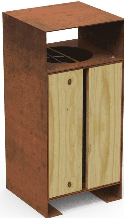
Papelera fabricada con **estructura de acero corten** de 6 mm. Con tablonces de **madera de pino tratada en autoclave** vacío-presión clase 4 contra la carcoma, termitas e insectos. Cubeta interior de acero galvanizado.
