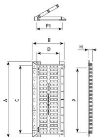
Impu está diseñada para soportar un tráfico suave. Perfecta para instalar en vías con una IMD de 500 a 1.000, especialmente en arcones y cunetas.
