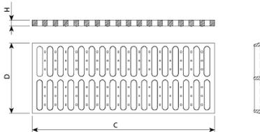
Mecalinea D4 está diseñada para soportar un tráfico medio. Perfecta para instalar en vías con una IMD de 1.000-20.000, especialmente calzadas de carreteras (incluyendo calles peatonales), arcenes estabilizados y zonas de aparcamiento para todo tipo de vehículos.
