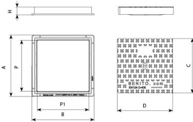
**Hidráulica D4** está diseñada para soportar un tráfico medio. Perfecta para instalar en vías con una IMD de 1.000-20.000, especialmente calzadas de carreteras (incluyendo calles peatonales), arcenes estabilizados y zonas de aparcamiento para todo tipo de vehículos
