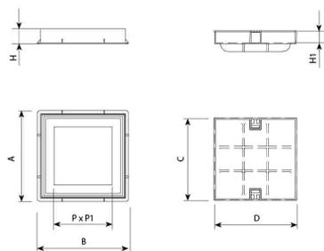
HRM D4 está diseñada para soportar un tráfico suave. Perfecta para instalar en vías con una IMD de 500 a 1.000, especialmente en arcones y cunetas.
