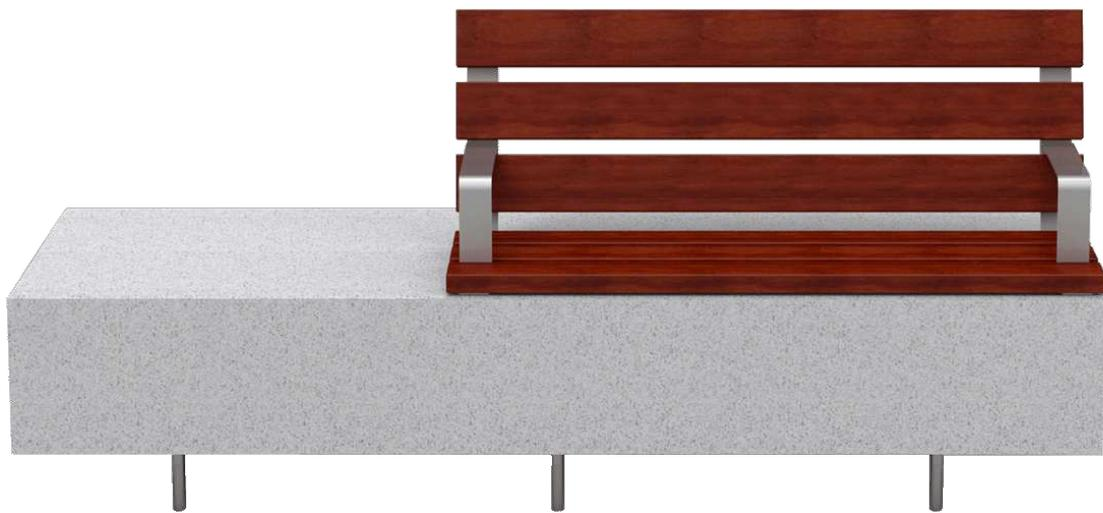
Banco fabricado con asiento de hormigón armado hidrófugo moldeado, color blanco granítico pulido. Estructura de acero inoxidable mate. Listones de madera tropical de sección 110 x 35 mm, tratada con el recubrimiento de triple capa Lignus , protector fungicida, insecticida e hidrófugo. Acabado color natural. Anclaje recomendado: Apoyado por su propio peso.
