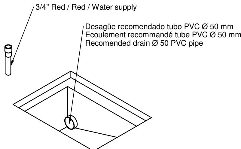
**NOTA:** presión recomendada entre 0,8 y 1,2 bar. Si la presión no es la correcta se debe instalar un regulador de presión. Instalar el reguladro en una arqueta adyacente.
