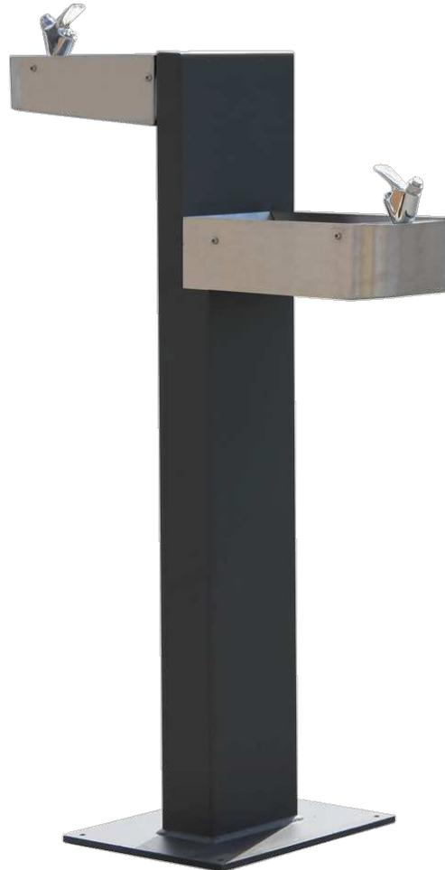
Fuente fabricada de acero con tratamiento Ferrus, proceso protector del hierro que garantiza una óptima resistencia a la corrosión. El tratamiento Ferrus se compone de tres capas que se aplican después de limpiar toda la suciedad y las impurezas mediante granallado y consiste en un baño electrolítico, seguido de una capa de imprimación epoxi y un último recubrimiento de pintura poliéster color gris martelé.
