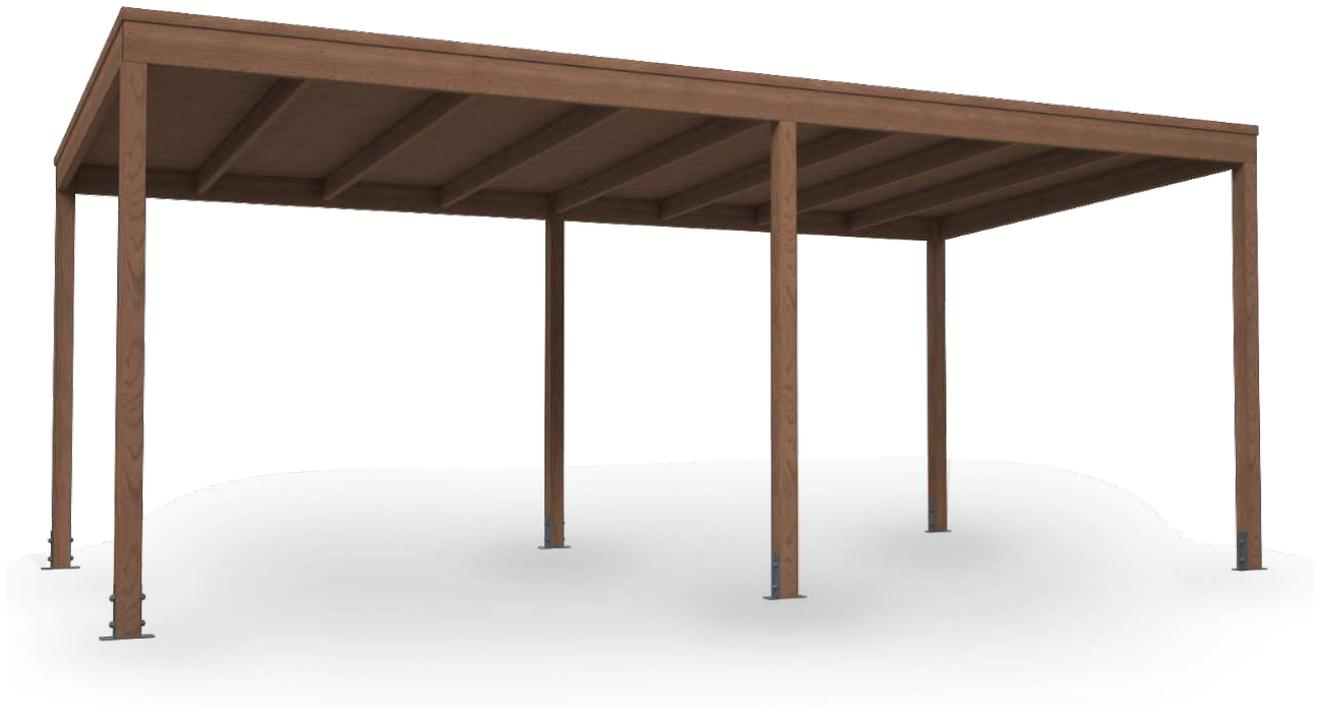
Pérgola autoportante 2 aguas de 6000x3000 en madera de pino Oregón Europeo (Douglas): pilares de 90x90, vigas de 170x45, viguetas de 140x45 y tabla machihembrada de 115x21. Acabado lasur, 100 % natural a base de aceites y resinas vegetales, con protector ultravioleta color roble dorado.
