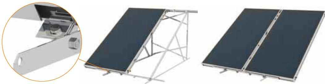
9. Apretar los tornillos en la base. Orientar apropiadamente la estructura con el captador. Fijar la estructura usando 4 anclajes y tirafondos (M8x60).
