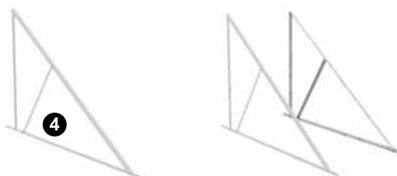
4. Colocar los perfiles 6 transversalmente y apretar los tornillos.
