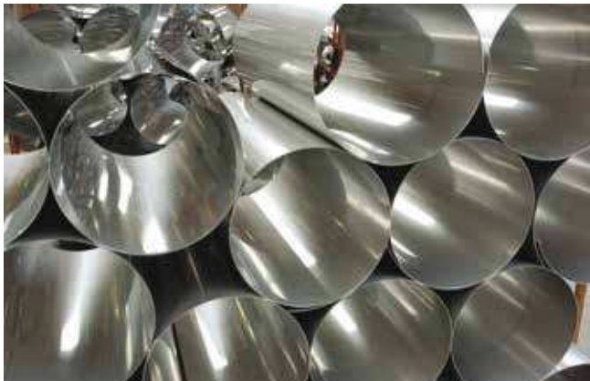
LÁMINAS ENROLLADAS DE ACERO INOXIDABLE EN ESPERA DE SER SOLDADAS
