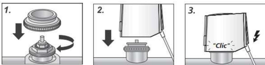
En el caso de necesitar desmontar el actuador termostático será necesario presionar ligeramente la ventana rectangular del frontal a la vez que se extrae verticalmente el actuador. Es recomendable desconectar la alimentación eléctrica siempre que se manipulen los actuadores.
