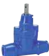
Serie 03/30 Válvula de registro con enchufes autoblocantes para tuberías de PE DN 20-50 PN 16 Fundición dúctil
