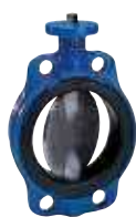
Serie 75/30 Válvula de mariposa Concéntrica con junta vulcanizada al cuerpo Tipo Semilug DN 50-200 PN 10/16 Fundición dúctil
