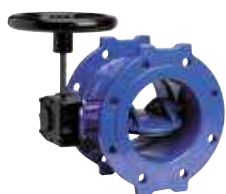
Serie 756/100 Válvula de mariposa Doble excéntrica Asiento integral reductor IP 67 DN 200-2800 PN 10/16 Fundición dúctil
