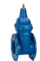
Serie 06/75 Válvula de compuerta embridada DIN F4 reemplazables en servicio DN 50-400 PN 10/16 Fundición dúctil
