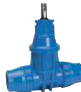
Serie 16/50 Válvula de registro con enchufes autoblocantes para tuberías de PE DN 25-50 PN 16 POM (Polioximetileno)
