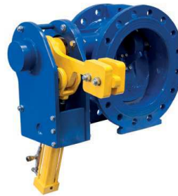
Serie 874/00-004 Válvula de retención de mariposa con contrapeso y amortiguador hidráulico EN 558-2, serie 14 DN150-1600 PN10/16 Cuerpo y disco de fundición dúctil Eje y asiento de acero inoxidable
