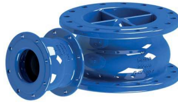
Serie 876/00-001 Válvula de retención de disco axial EN 558-2, serie 14 DN50-600 PN10/16 Fundición dúctil Disco revestido EPDM Eje acero inoxidable Tornillería A2
