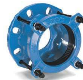
Serie 603/A-6100 SBrida universal DN40-400 PN16 Fundición dúctil Caucho EPDM Tornillos acero 8.8 revestidos de Sheraplex
