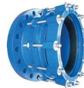
Serie 8004/04-001 Brida universal Super-Hydro DN300-2000 PN10/16 Acero S235JR Caucho EPDM Tornillos acero 8.8 cincados
