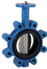
Serie 820/10-029 Válvula de mariposa concéntrica LUG EN 558-1, serie 20 DN25-600 PN10/16 Fundición dúctil Disco AISI 316 Junta EPDM Opcional: Disco fundición dúctil revestido de rilsan
