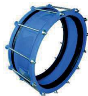
Serie 8004/01-001 Unión recta universal Super-Hydro DN50-2000 PN10/16 Acero S235JR Caucho EPDM Tornillos acero 8.8 cincados
