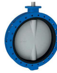
Serie 820/20-025 Válvula de mariposa concéntrica Sección en U EN 558-1, serie 20 DN150-1600 PN10/16 Fundición dúctil Disco AISI 316 Junta EPDM Opcional: Disco fundición dúctil revestido de rilsan
