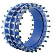
Serie 873/00-001 Carrete de desmontaje con brida central DN40-2600 PN10/16/25 Fundición dúctil Caucho EPDM Varillas acero 8.8 cincado
