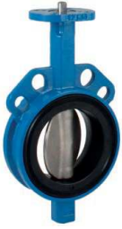
Serie 820/00-025 Válvula de mariposa concéntrica Wafer EN 558-1, serie 20 DN25-1000 PN10/16 Fundición dúctil Disco AISI 316 Junta EPDM Opcional: Disco fundición dúctil revestido de rilsan
