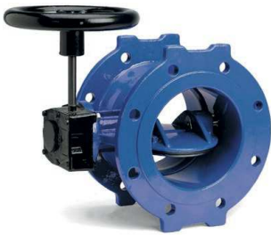
Serie 756/218-005 Válvula de mariposa doble excéntrica EN 558-2, serie 13, corto DN150-600 PN10/16 Fundición dúctil Eje inoxidable Caucho EPDM
