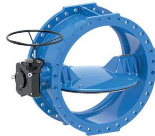
Serie 756/218-001 Válvula de mariposa doble excéntrica EN 558-2, serie 13, corto DN700-1200 PN10/16 Fundición dúctil Eje inoxidable Caucho EPDM
