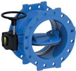
Serie 756/118-012 Válvula de mariposa doble excéntrica EN 558-2, serie 14, larga DN150-600 PN10/16 Fundición dúctil Eje inoxidable Caucho EPDM
