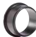
Serie 05 Sellado de combi-bridado para uPVC, acero o tuberías en fundición dúctil No antitracción Caucho SBR DN 400-600 (uPVC and ductile) DN 50-300 (steel)
