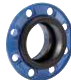
Serie 05 Combi-bridado para tuberías de PE y PVC Antitracción Fundición dúctil DN 50-300 PN 10/16
