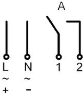
Conectar el voltaje y frecuencia como indica la etiqueta de características del aparato y de acuerdo con los esquemas del interruptor horario y del aparato eléctrico a programar.
