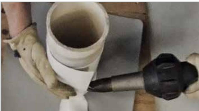
PASO 2. Soldar por puntos PF340 para ajustar la penetración
