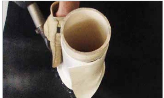
PASO 4. Soldadura del final de NR a la sección
