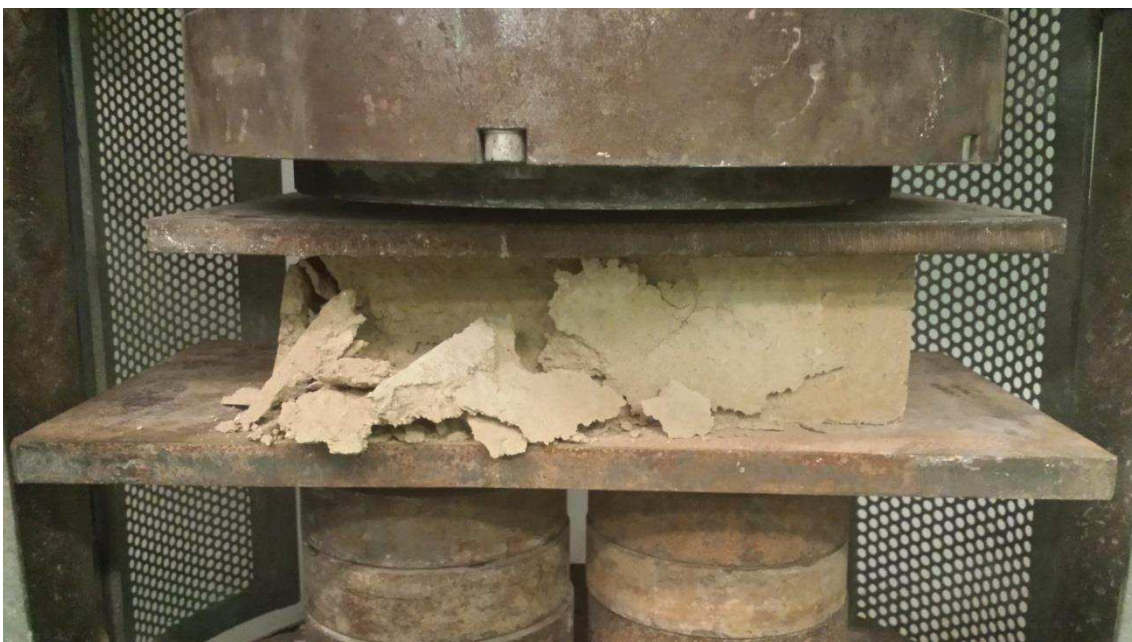
Bloque de tierra comprimida después de la rotura
