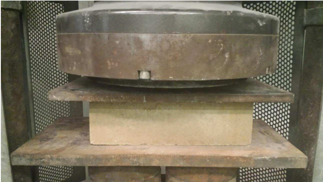
Bloque de tierra comprimida antes de la rotura
