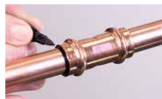
7B. Como alternativa marque la profundidad de inserción usando el accesorio
