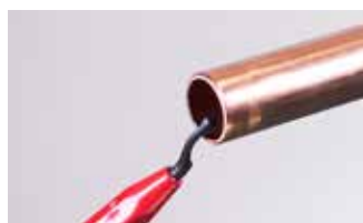
3. Utilice un desbarbador tipo lápiz para los bordes internos
