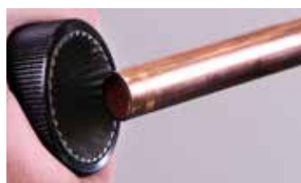
2. Desbarbe y elimine todos los bordes afilados externos
