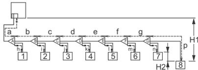
**Ejemplo 2:** Ramificación con junta Refnet y colector Refnet.
