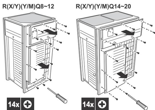
Una vez que las placas delanteras estén abiertas, se puede acceder a la caja de componentes eléctricos retirando la cubierta de la caja de componentes eléctricos de la siguiente manera.
