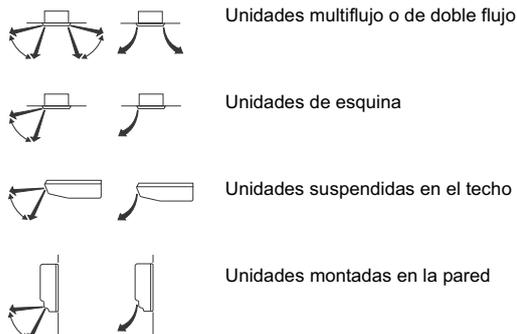
En las siguientes condiciones, el microordenador controla la dirección del flujo de aire, que puede ser diferente del que se muestra.
