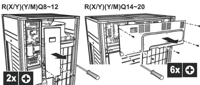
Para fines de mantenimiento, se debe acceder a los pulsadores de la PCB principal. Para acceder a estos pulsadores, no es necesario abrir la cubierta de la caja de componentes eléctricos. Consulte "13. Realización de ajustes de campo" en la página 32.
