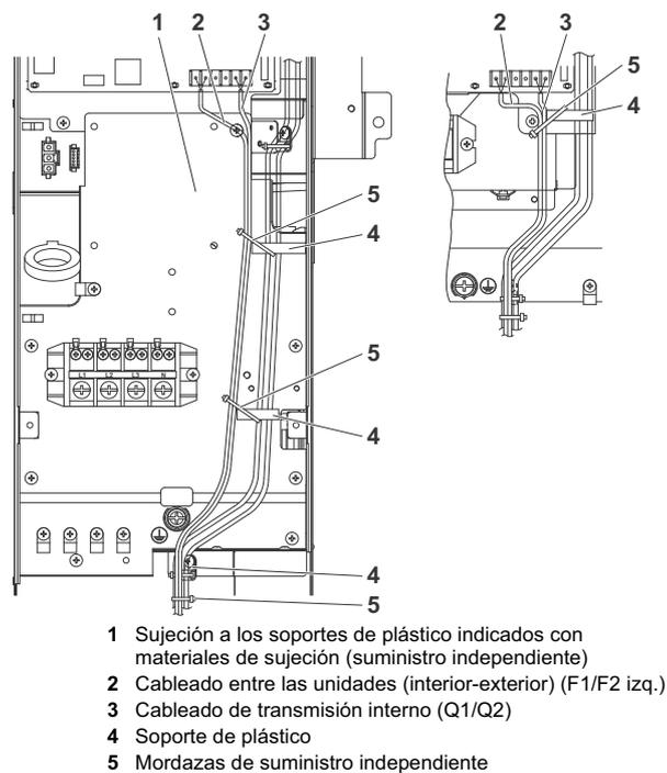
Preste una especial atención al conectar los cables al bloque de terminales.
