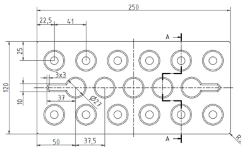
Figura 1. Detalles de la pieza GEROBLOK PERFORADO 50 dBA.
