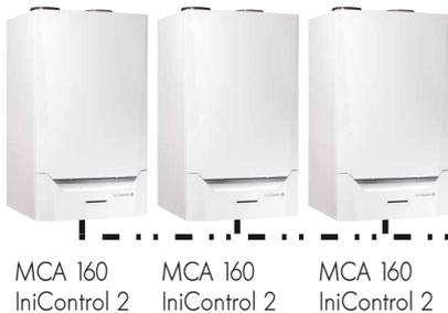
Todas las calderas (hasta un máximo de 7) se conectan a través de contactos 0 – 10 V a un armario de distribución de la sala de calderas que gestione la cascada y todos los circuitos secundarios (ver página 23).
