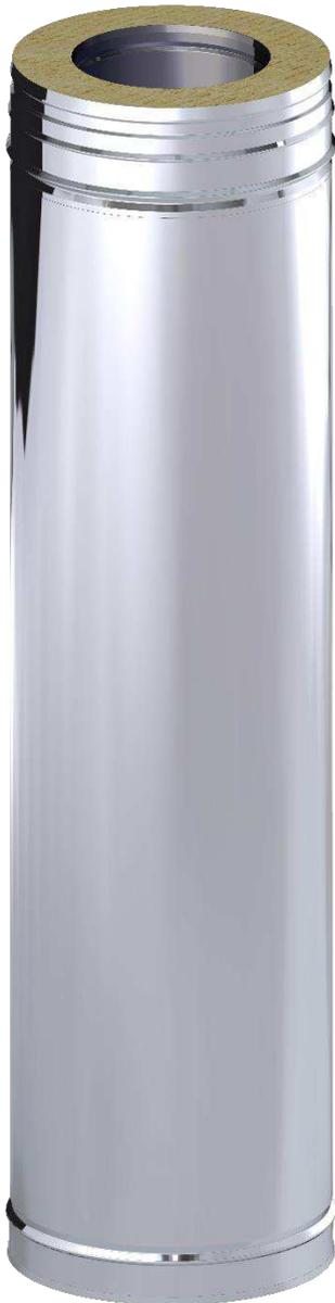
Chimenea modular de doble pared de acero inoxidable con junta de estanqueidad exterior y aislamiento intermedio de 50 mm de lana de roca de 100 kg/m<sup>3</sup> de densidad
