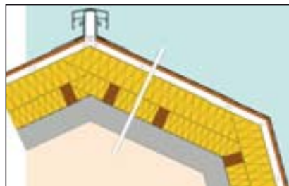
Estructura de tejado con diferentes pendientes
