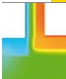
Los puentes térmicos se reducen en gran medida
