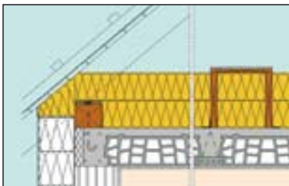
Aislamiento en el techo de la planta superior
