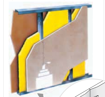
Esquema del Sistema Placo para tabiquería. Esquema do Sistema Placo para divisórias.
