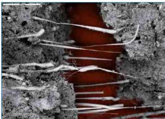
*Fibras de Vidrio dentro la parte central de una placa Glasroc F (Stucal).*
