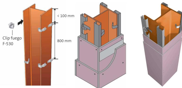
Es la solución idónea para la protección de perfiles laminados en caliente, mediante la combinación de placas PPF se logran altas prestaciones frente al fuego.
