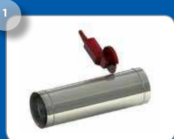
CORTAR EL TUBO EXTERIOR A LA MEDIDA REQUERIDA
