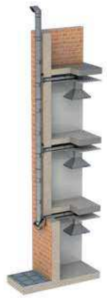
VENTILACIÓN CON CANALIZACIÓN INTERIOR
