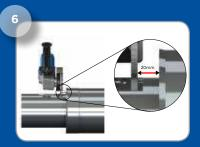
ASEGURAR UN MARGEN MÍNIMO DE 20 MM ENTRE EL CORTE Y EL TUBO EXTERIOR
