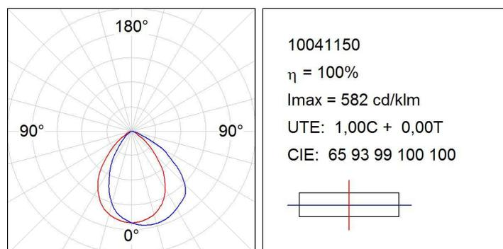
**Flujo de salida:** 2.737 lm      **Eficacia:** 67,6 lm/w
