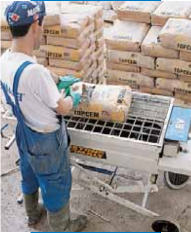
Mezcla de Topcem con mezclador con sinfín
