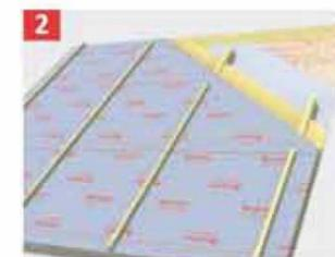
Fijar la lámina directamente y mecánicamente a los rastreles, viguetillas o soporte. Fijar rastreles sobre la lámina y a través de los puntos de fijación de esta, hasta los rastreles primarios, viguetillas o soporte, para proteger la zona de fijación.
