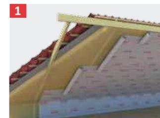
1 Extienda la lámina a prueba de vapor ONDUTISS® BARRIER sobre el soporte de la cubierta, se ha de colocar en la cámara caliente del edificio, antes del aislamiento. Empiece a colocar la membrana de alero a cumbre, siempre con la cara impresa hacia el exterior. El solape entre láminas está indicado mediante líneas longitudinales impresas en el producto.
