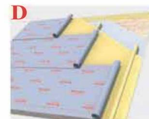
Desplegar ONDUTISS® AIR perpendicular a la pendiente, empezando desde el alero, con la parte impresa hacia arriba. La lámina se puede instalar directamente sobre el aislamiento con una ligera tensión. El solape está indicado mediante líneas impresas o el logotipo. Para una mayor impermeabilidad, sellar las juntas con cinta autoadhesiva de butilo Ondufilm.
