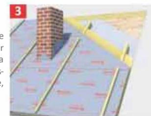
En los casos donde existan elementos que sobresalgan de la cubierta como: chimeneas, claraboyas, ventanas, etc. cortar ONDUTISS® AIR por la parte del ancho (1,5 m) y colocar sobre los elementos salientes. Fijar ONDUTISS® AIR con la lámina de butilo autoadhesiva Ondufilm.
