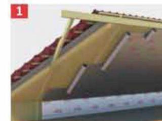
Desplegar la lámina barrera de vapor ONDUTISS® BARRIER REFLEX sobre los rastreles por la parte caliente de la cubierta (debajo de la capa aislante). Comenzar a instalar desde la parte inferior hacia la cumbrera, quedando la parte impresa con el logo visible. El solape está indicado mediante líneas o con el logo impreso.
