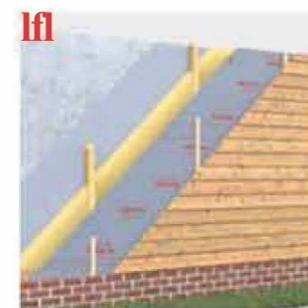
Fijar ONDUTISS® AIR con rastreles a la estructura. Instalar los elementos de revestimiento (paneles de fachada, placas metálicas, etc.) la cámara de ventilación entre ONDUTISS® AIR y el revestimiento debe de ser de al menos 3 cm.
