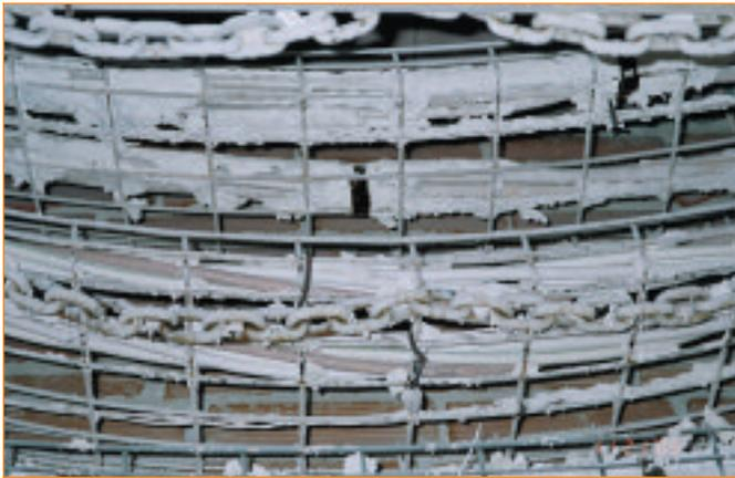
**Figura 3:** La instalación al finalizar el ensayo y alcanzados los 1.000°C.
