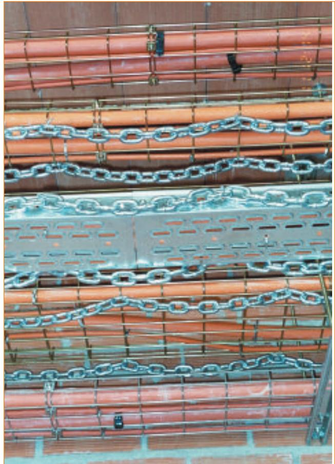
En la figura de la página anterior (1): Instalación con Rejiband a la vista. Arriba (figura 2), instalación para el ensayo según DIN-4102-12 con cables libres de halógenos y resistentes al fuego.
