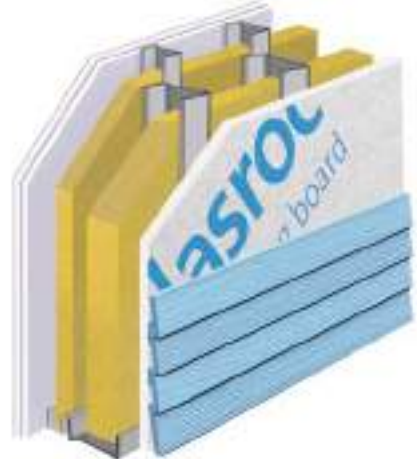
Muro exterior de hoja doble con envolvente exterior
