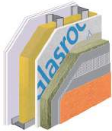
Muro exterior de hoja simple con SATE
