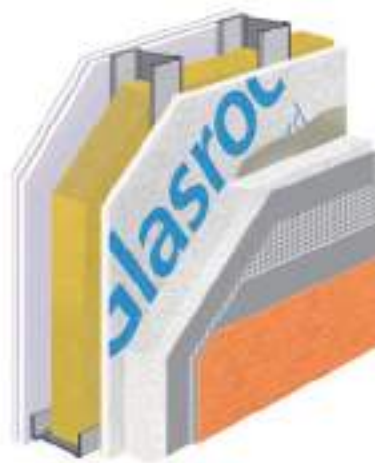
Muro exterior de hoja simple con SATE
