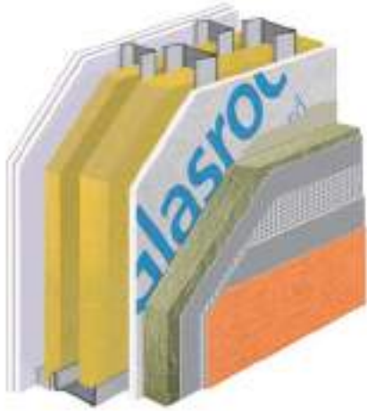
Muro exterior de hoja doble con SATE
