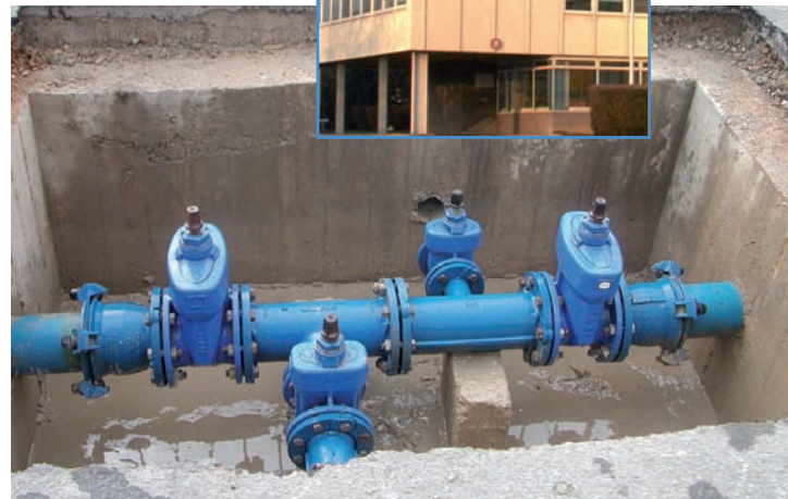
Ejemplo: Euro 20 DN 100. Según norma UNE EN 1074 el momento flector a aplicar será de 2200 Nm y no se detectará ninguna fuga visual en el sistema.
