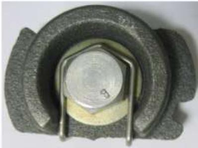
Atornillar utilizando la fuerza correcta del par de apriete (120Nm) y orientar el tornillo hacia la apertura de la leva, desatornillando eventualmente si fuera necesario para conseguirlo.
