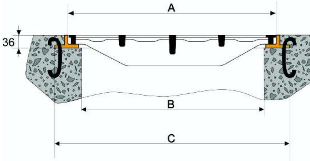
Perfiles de sujeción con diferencia máxima de nivel entre los dos lados de 3 mm, y a lo largo de la rejilla de 2 mm.
