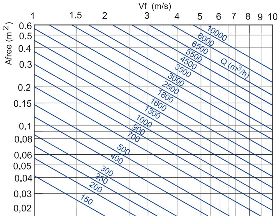
Determinación del caudal de aire. Midiendo Vf en diferentes puntos de la rejilla hallamos Vfmed.
