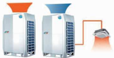
Etapa 1: Funcionamiento en modo calefacción continua
