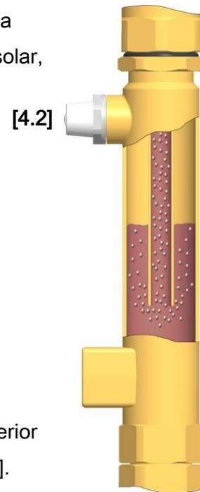
El aire separado del líquido caloportador se acumula en la parte superior del separador y puede evacuarse a través el tapón del purgador [4.2].
