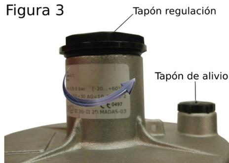
Para aumentar o disminuir la presión de salida, hay que realizarlo en dinámica (con consumo). Actuar sobre el regulador, sacar el tapón de regulador y con una llave allen de 12 mm, girar la tuerca (figura 4) en sentido horario para aumentar la presión y en sentido antihorario para disminuirla. Una vez ajustada la presión deseada (dentro de los límites indicados) volver a colocar el tapón de regulación.
