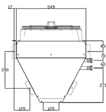
\* Arriba se muestra la posición de las sujetaciones. La ubicación de esos elementos para varias posiciones de instalación se muestra en el capítulo 4.
