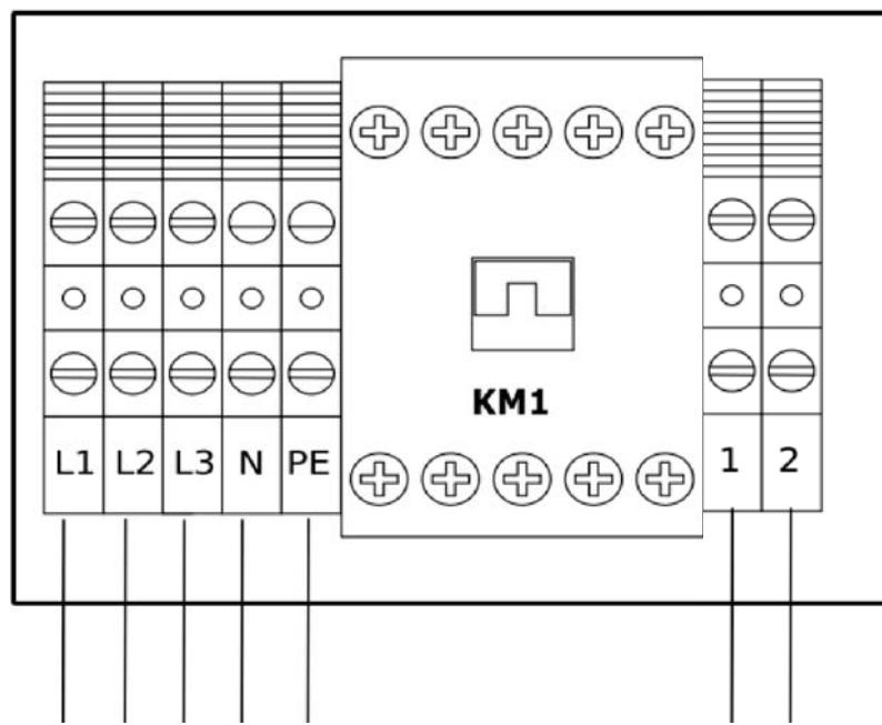
Dispositivo de activación 230V (L,N) o concentrador RX (V;N)
