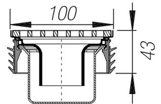
Marco de contorno con rejilla de diseño de acero inoxidable CURVE, con soporte y sifón integrado
