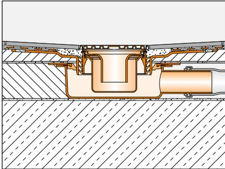
El anillo circular de 5 mm se puede retirar y reducir así la altura a 70 mm. En cumplimiento de la norma DIN 1253 y para alcanzar la capacidad de desagüe de 0,4 l/s, se debe garantizar una sección transversal de 32 mm (H\*\*). En caso necesario se debe cortar el desagüe con platillo
