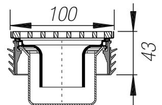
Marco de contorno con rejilla de diseño de acero inoxidable PURE, con soporte y sifón integrado
