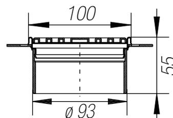
Pieza portadora de acero inoxidable con soporte y anillo de fijación de altura
