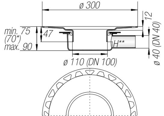
Conjunto de desagüe DN 50 con sifón, salida opcional DN 40 (40mm), salida DN 50 (50mm) con conexión articulada
