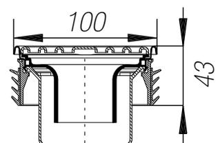
Pieza portadora de acero inoxidable para recubrimientos, con soporte y sifón integrado
