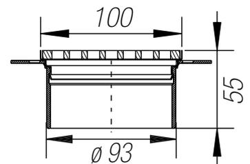
Marco de contorno con rejilla de diseño de acero inoxidable PURE, con soporte y anillo de fijación de altura Marco de contorno de 100 x 100 mm, posibilidad de desplazamiento en todas las direcciones para grosores de 3 a 30 mm
