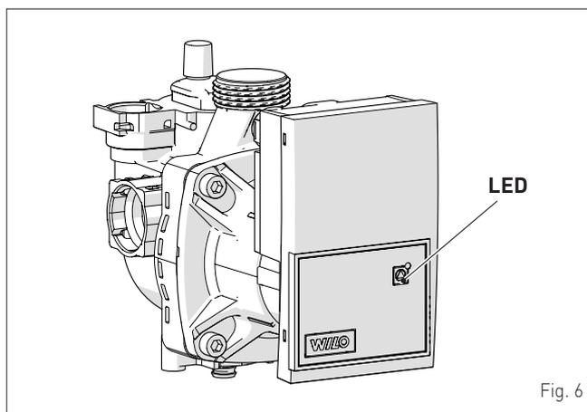
Las calderas **Brava Slim HE 35 ErP** y **Brava Slim HE 40 ErP** utilizan la bomba equipada con LED de señalización que indica:
