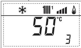
4. Visualisation température sonde auxiliaire ou sonde bouilleur (SB)
