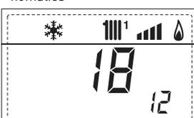
13. Compteur accès aux paramètres installateur (exemple 140 accès)
