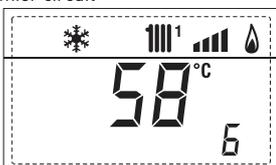
7. Visualisation température chauffage du deuxième circuit
