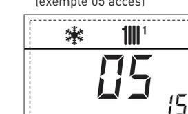
17. Affichage débit sanitaire débitmètre (18 l/min et 0,31 l/min) ou condition du débitmètre (respectivement ON et OFF)
