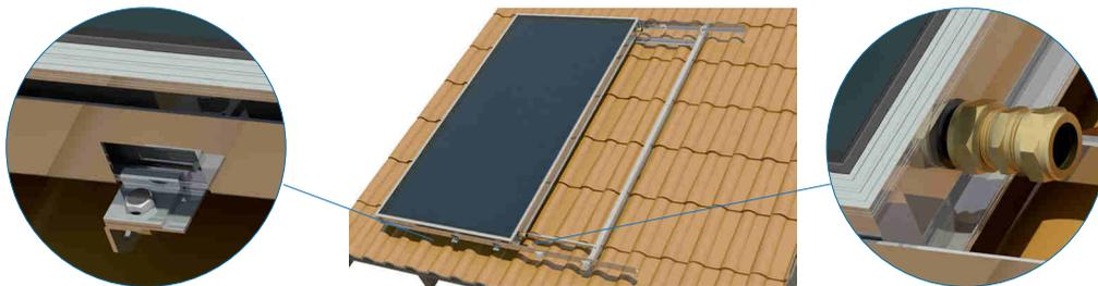
7. Una el segundo colector y ajuste los racores.\*
