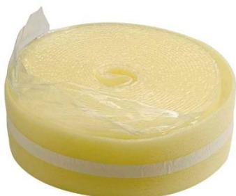
La banda perimetral se fija antes de la colocación de la placa aislante y realiza funciones mecánicas y térmicas. Aísla, perfecta e independientemente, la base del sistema y los muros exteriores e interiores, permite la dilatación que sufrirá la losa de mortero por efecto del calentamiento y evitando puentes térmicos.
